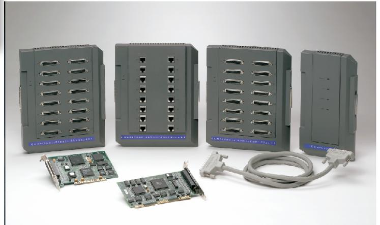
El IntelliPort Plus EX es una solución de I/O mapped multi-puertos inteligente para acceso remoto que combina la expansión modular con un eficiente buffer de datos y baud rates garantizado de hasta 460 Kbps.
